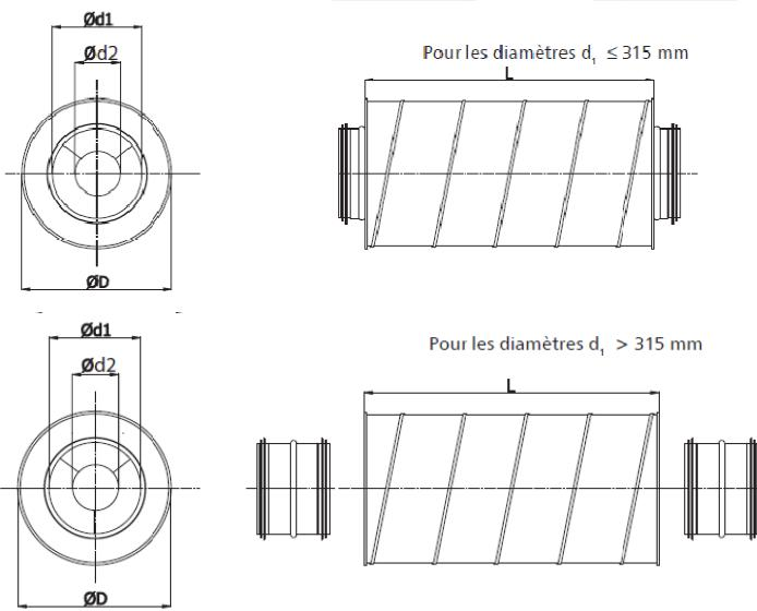
Les silencieux circulaires sont composés d'une tôle galvanisée pleine à l'extérieur et d'une tôle perforée à l'intérieur.
